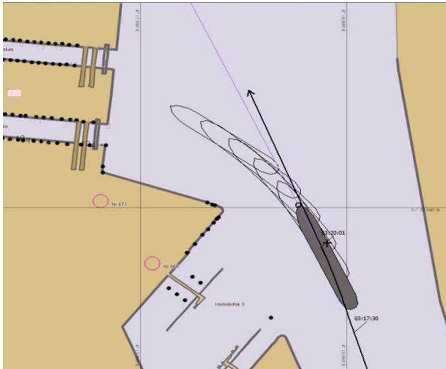
Figur 5 – Bilde av både vektor og predictor i ECDIS (Ryan, 2010).
